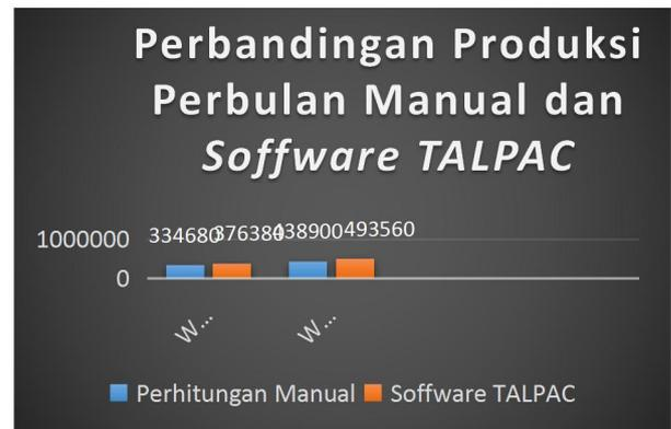
Gambar 5 Grafik perbandingan Produksi 6 unit wheel loader 800 dan 3 unit wheel loader 900 perhitungan manual dan Talpac
