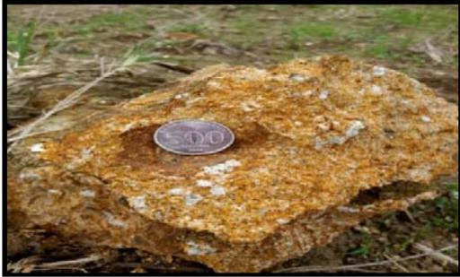
Foto 3. Bongkahan tufa yang telah mengalami oksidasi
