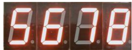
Gambar 4.1.4 Angka Yang Ditampilkan Seven Segment
