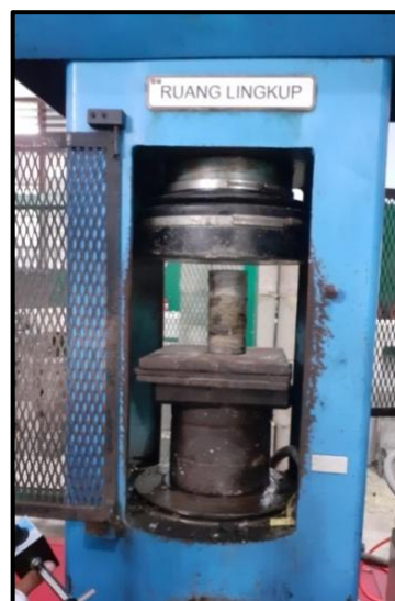
Gambar 3.7 Pengujian Kuat Tekan Uniaksial Batuan ( \sigma_c )
