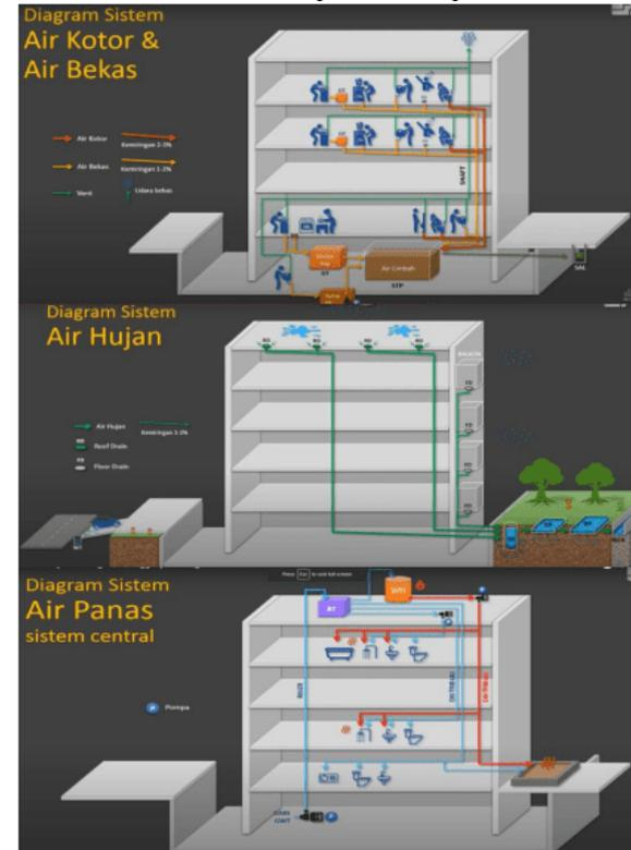
**Gambar 4.9.** Sistem Pembuangan Air Kotor, Air Hujan, dan Air Panas
