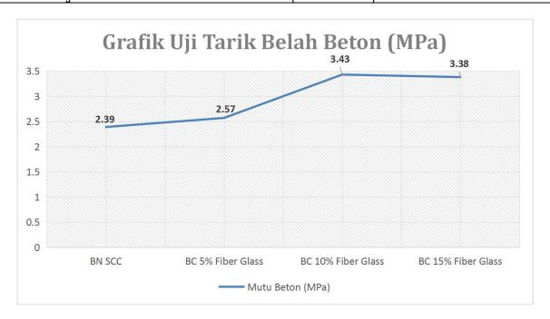
Didapatkan nilai uji tarik belah beton dengan nilai 2,39 MPa untuk beton normal. Mengalami peningkatan pada beton dengan campuran fiber glass 5% dengan nilai 2,57 MPa. Dan mengalami peningkatan pada beton campuran fiber glass 10% yaitu 3,43 MPa. Mencapai niai optimal pada beton campuran kawat bendrat 15% dengan nilai 3,38 MPa. Peningkatan nilai uji tarik belah pada beton campuran serat kaca/ fiber glass disebabkan fiber glass memiliki modulus elastisitas yang tinggi.
