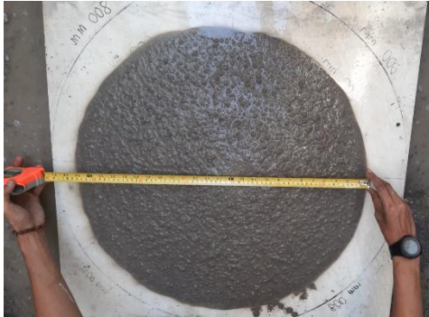
Gambar 3. Pengujian Uji Slump Flow Beton SCC 20% Penambahan Serbuk Limbah Botol Kaca
