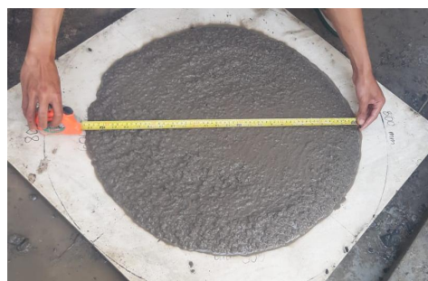
Gambar 2. Pengujian Uji Slump Flow Beton SCC 10% Penambahan Serbuk Limbah Botol Kaca
