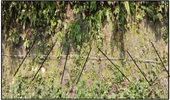
Gambar 8. Pengukuran Scanline Pada Lereng 2
