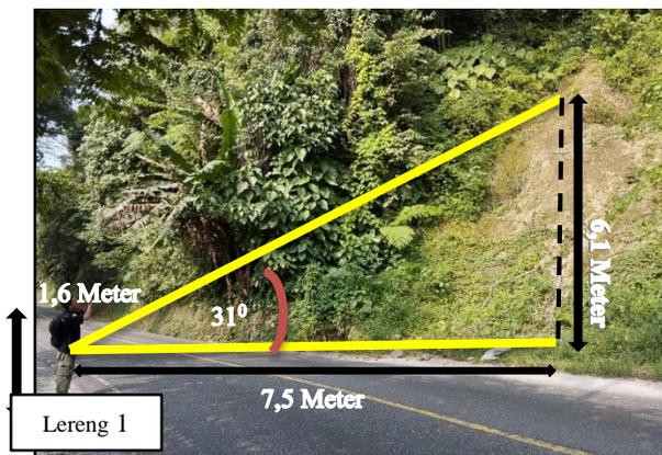
Gambar 9. Pengukuran Slope Lereng 1
