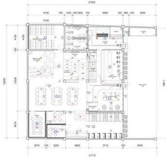
Gambar 119. Pengaplikasian Sprinkler, Smoke Detector dan Elektrikal
