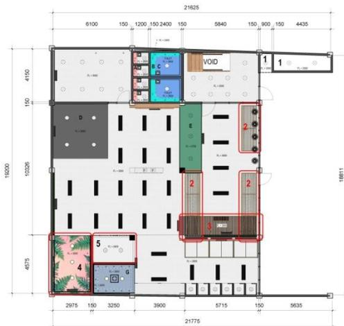
Gambar 103. Area Pengaplikasian Kayu dan Rotan/Bambu pada Bagian Atas Ruangan
