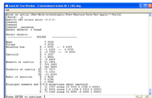
Gambar 8. Tampilan perhitungan setelah ditekan Enter pada keyboard. Terlihat jelas hasil perhitungan volume pondasi batu kali tersebut
