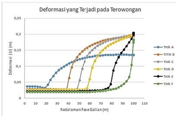
**Gambar 4.6.** Grafik Deformasi versus Kedalaman Fase Galian Model Tanpa Perkuatan
