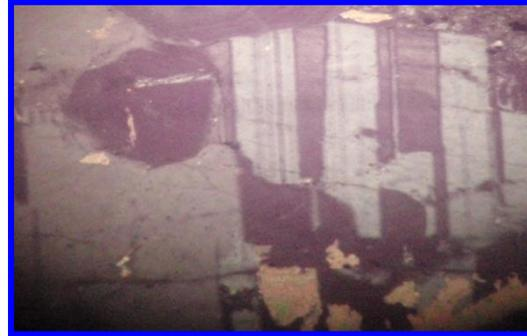
**FOTO 1** : Zona alterasi argilik menengah : **kiri**, sample core andesit hornblendeterubah jadi klorit; **kanan**, petrografi fenokris plagioklas terubah jadi klorit
