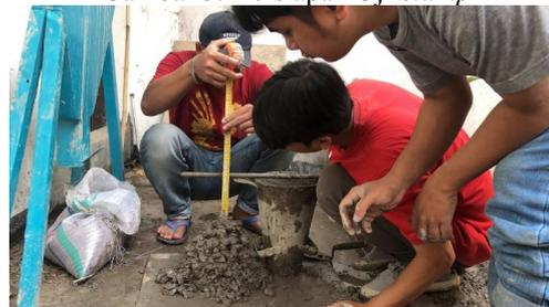
Gambar 4. Pengukuran Uji *Slump*
