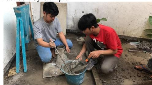
Gambar 3. Persiapan Uji *Slump*
