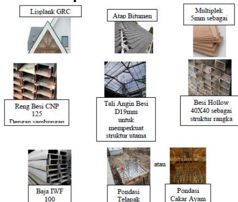
Gambar 5.14. Konsep Struktur dan Konstruksi Sumber: Analisa Pribadi
