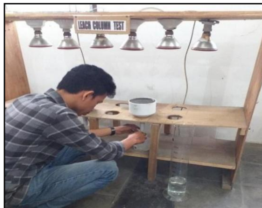
Gambar 2. Penampungan air lindian yang turun dengan gelas ukur
