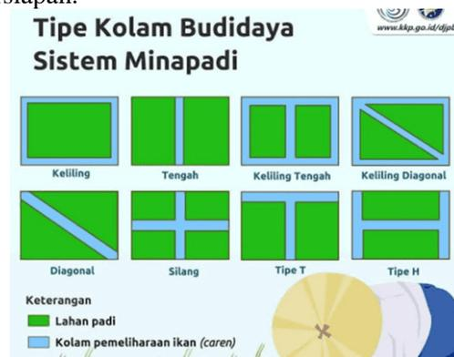
Gambar 2.1. Konstruksi kamalir atau caren pada Mina Padi
